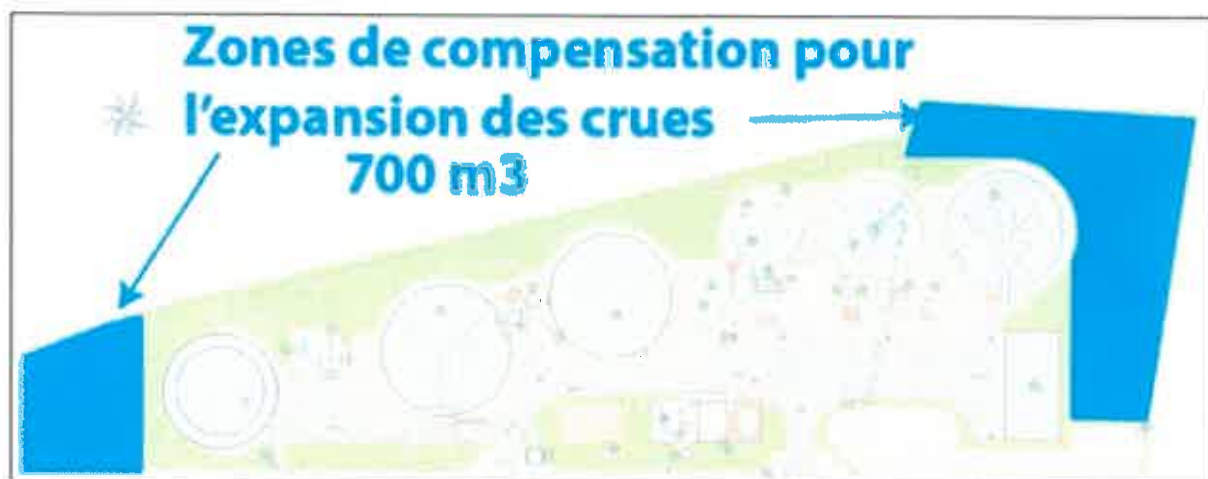
Carte de localisation des deux zones de compensation pour l'expansion des crues
